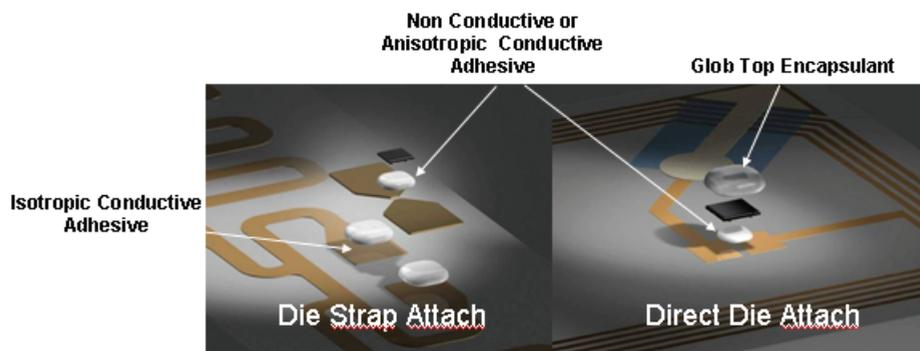
Fig. 15. Die strap and direct die attach
